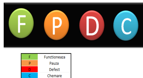
Figura 4.2 Panoul secundar la fiecare post de lucru
