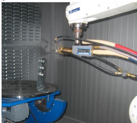
Fig. 2. Modul de fixare a probelor pe masa rotativă pentru pulverizare
